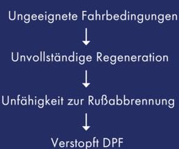
Der Austausch eines verstopften DPF ohne eine korrekte Analyse des ursprünglichen Fehlers führt lediglich dazu, dass der neue DPF ebenfalls sich verstopft!
